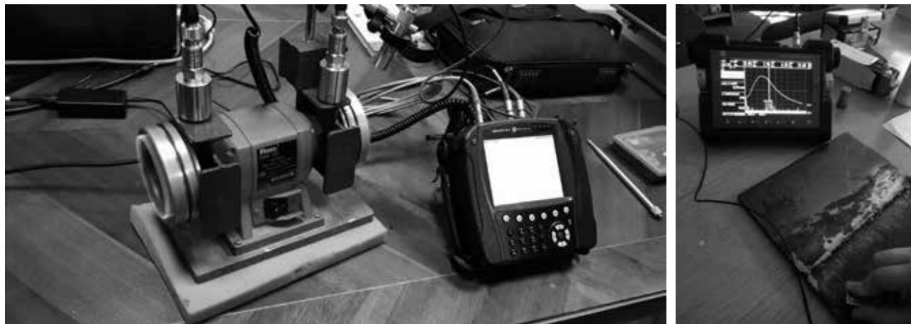
Vibracijska dijagnostika i ispitivanje zavarenih spojeva ultrazvukom
